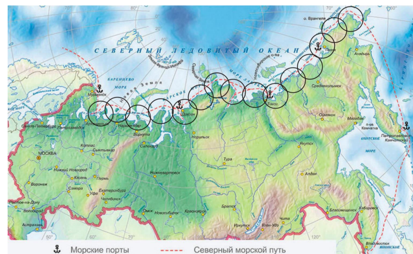
Рис. 1 Рекомендуемое расположение береговых станций и радиус их действия
