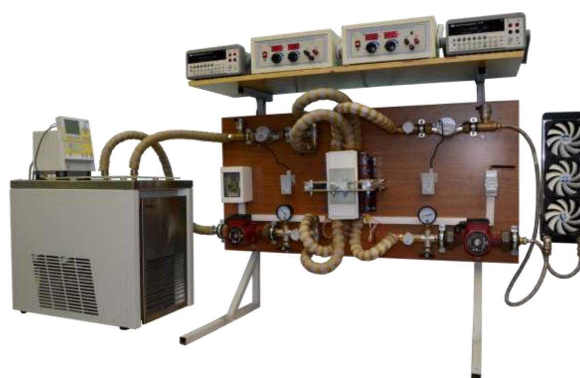
Аппаратно-программный измерительный комплекс для исследования основных параметров тепловых насосов
