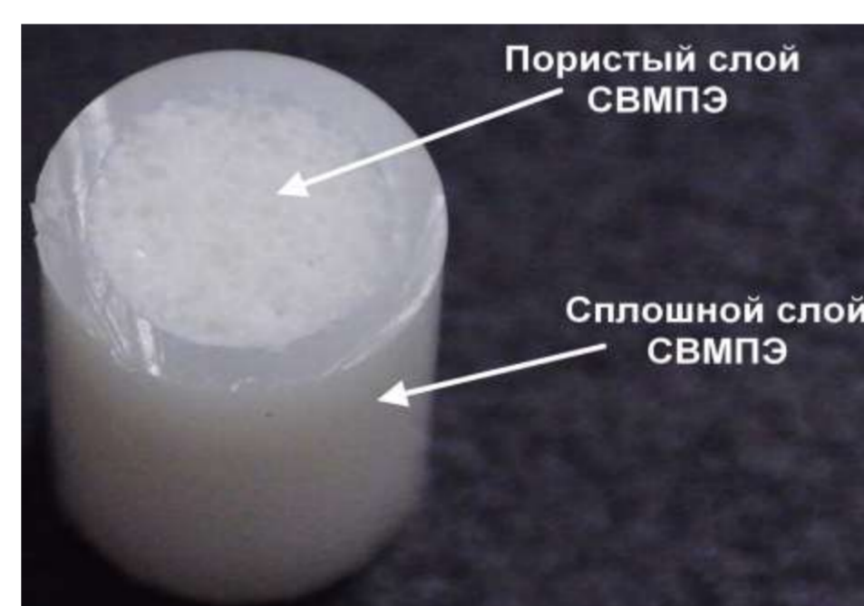
Рис.2 экспериментальный образец биоинженерной конструкции на основе пористого СВМПЭ
