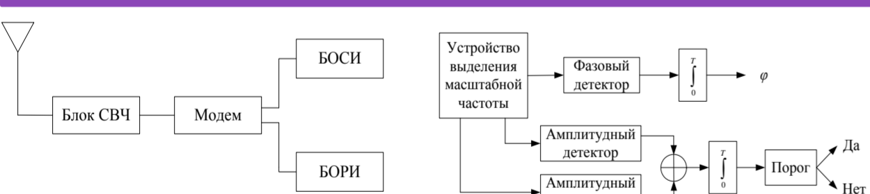
Рис. 1. Структурная схема многофункционального комплекса радиосвязи и радиолокации (БОРИ – блок обработки радиолокационной информации, БОСИ – блок обработки связной информации)
