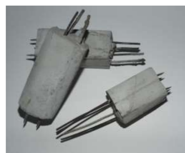
Рисунок 8 - Исходный материал для дробления – образцы отходов железобетона
