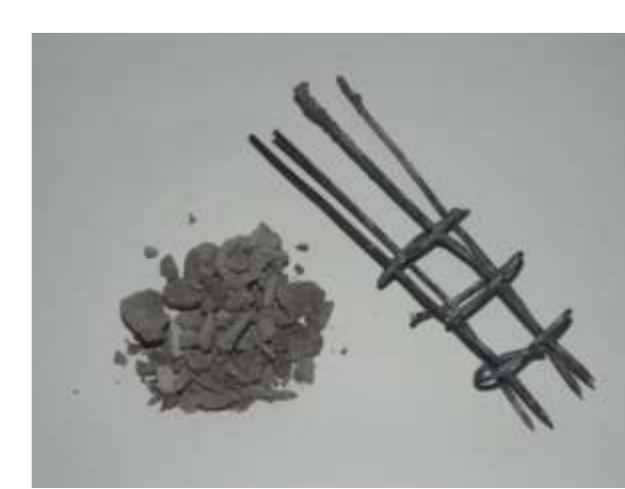
Рисунок 9 - Результат дробления железобетона
